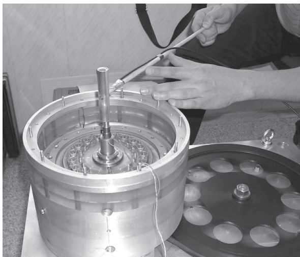
Рис. 3. Измерение магнитного поля вокруг вращающейся магнитной системы
