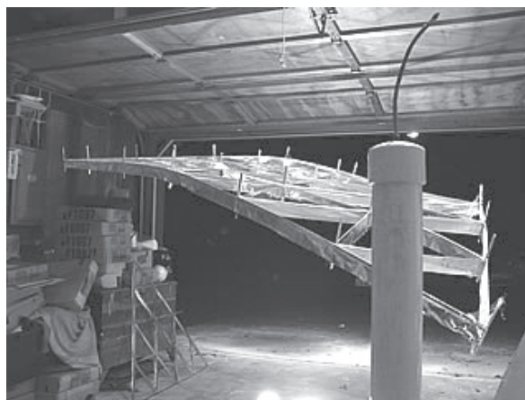
Рис. 5. Несколько клеток увеличивают производительность тяги и общую эффективность. Lifter-9 состоит из 36 клеток, общий воздушный зазор – 100 футов! Поскольку каркас устройства прогибается от направленной вверх тяги, проволоочная корона становится жестче, улучшая производительность и эффективность. Lifter-9 работает, используя обычное высоковольтное энергоснабжение, но для максимальной эффективности ему необходим более высокий уровень тока
