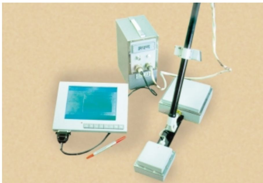
Рис. 1. Радар среднего разрешения для глубин до 3 м в сборе (приемо-передающий блок, блок обработки, индикатор)
