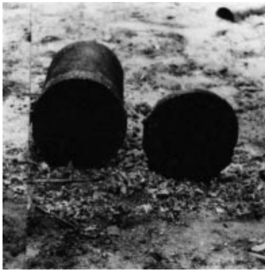
Рис. 3. Фотография стального цилиндра диаметром ~500 мм, разрезанного с помощью ударных волн разрежения.
