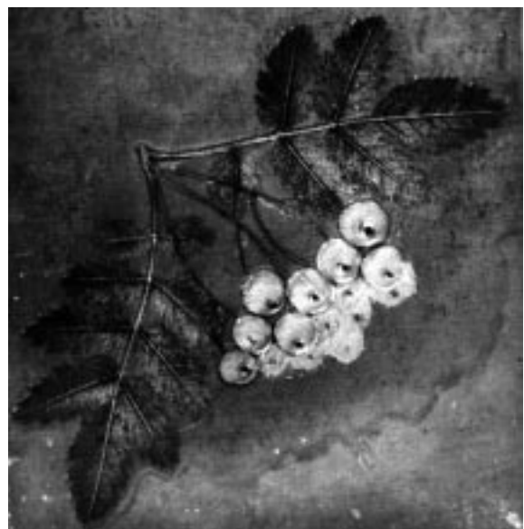
Рис. 4. Фотография отпечатка ветки рябины на медной пластине при детонации тонкого слоя взрывчатого вещества.
